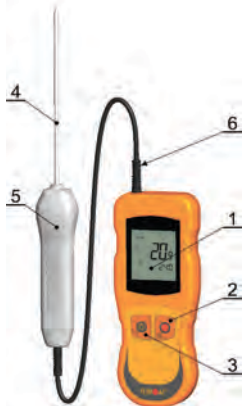
Рис. 1 Основные части прибора ТК-5.01С, органы управления
