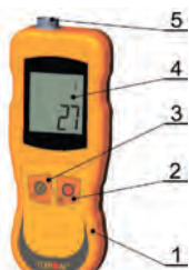
Рис.5 Основные части прибора ТК-5.04С, органы управления
