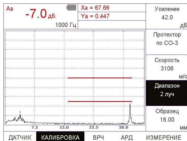
в) Калибровка диапазона для контроля однократно отраженным лучом
