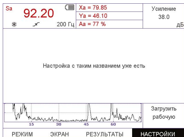
Рис. 3-21 Окно прибора при попытке сохранить настройку с уже существующим именем
