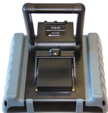
Рис. 1-2 Прибор со снятой крышкой аккумуляторного отсека
