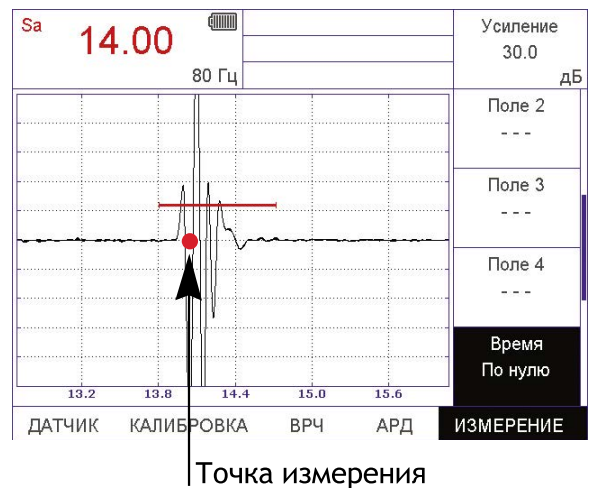
Рис. 3-5 Измерение времени прихода сигнала «по нулю»
