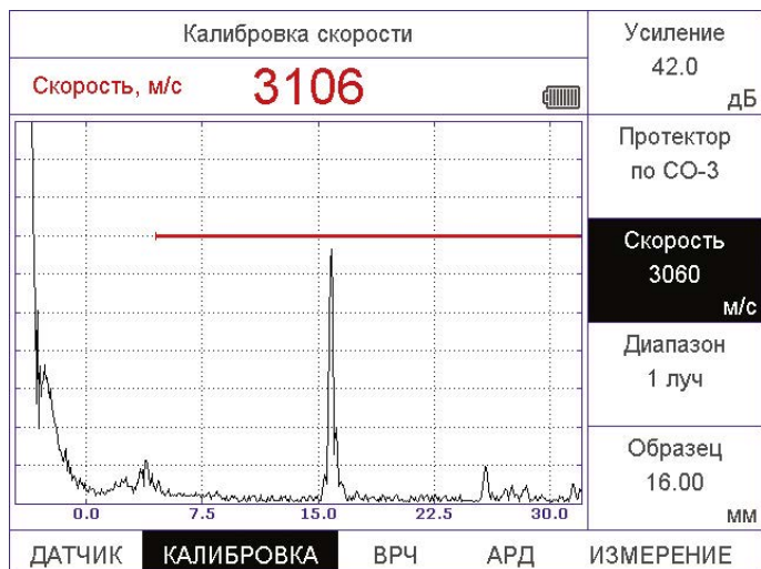
Рис. 3-18 Экран калибровки наклонного преобразователя по СОП толщиной 16мм
