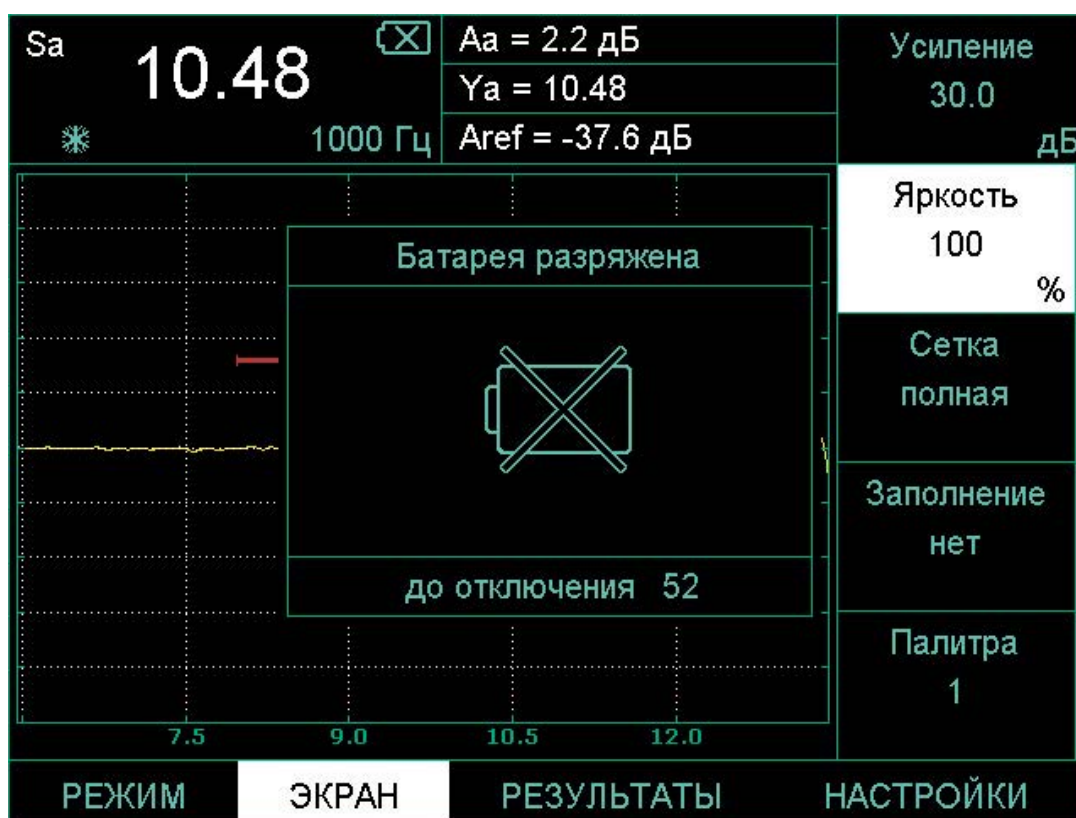
Рис. 1-6 Индикатор разряда аккумулятора
