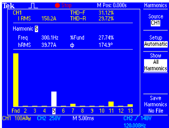
Измерение гармонических искажений с помощью ПО TPS2PWR1.
