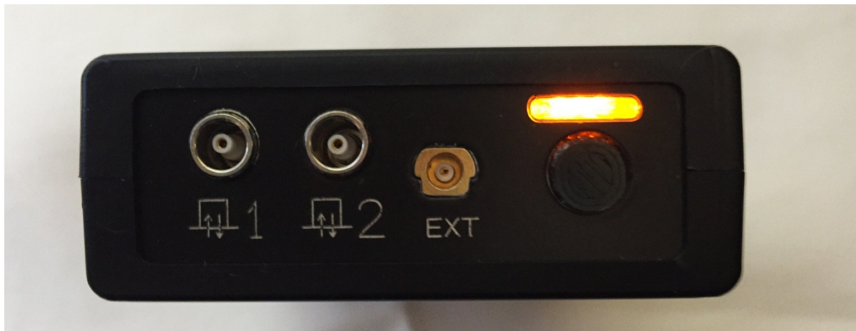
Рис. 7. Индикатор сигнализации дефекта и заряда батареи
