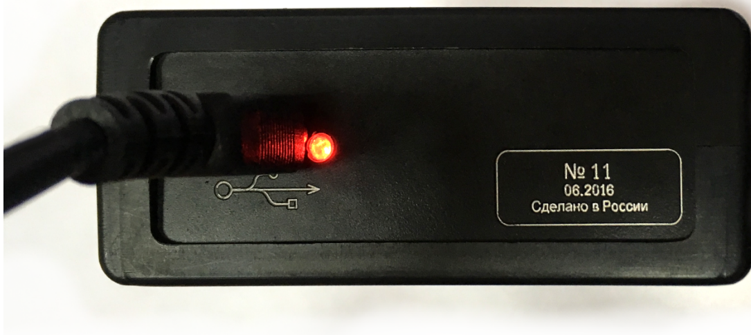
Рис. 4. Зарядка электронного блока
