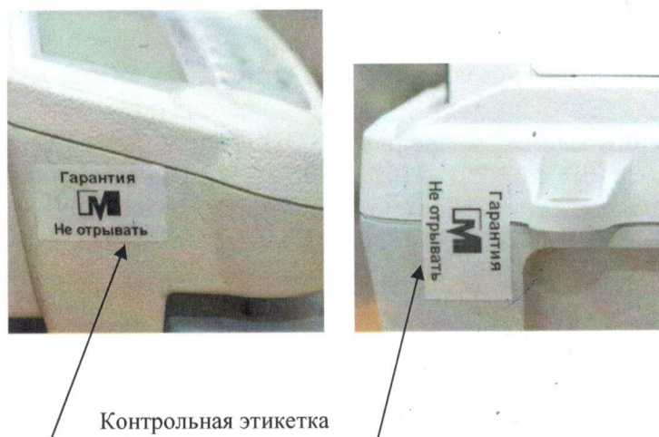
Рисунок 2 - Схема пломбирования от несанкционированного доступа
