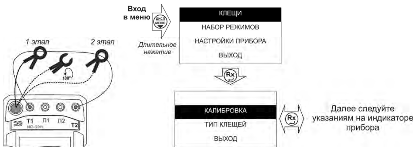
Рисунок 2.14 – Калибровка токоизмерительных клещей
