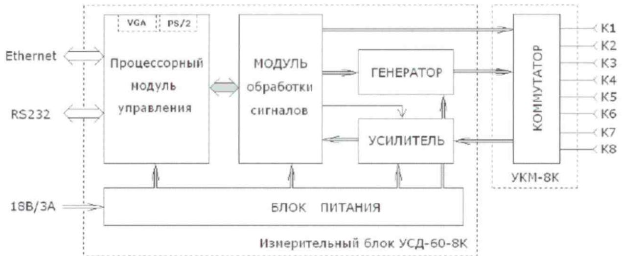
Рисунок 1 – Функциональная схема дефектоскопа УСД-60-8К
